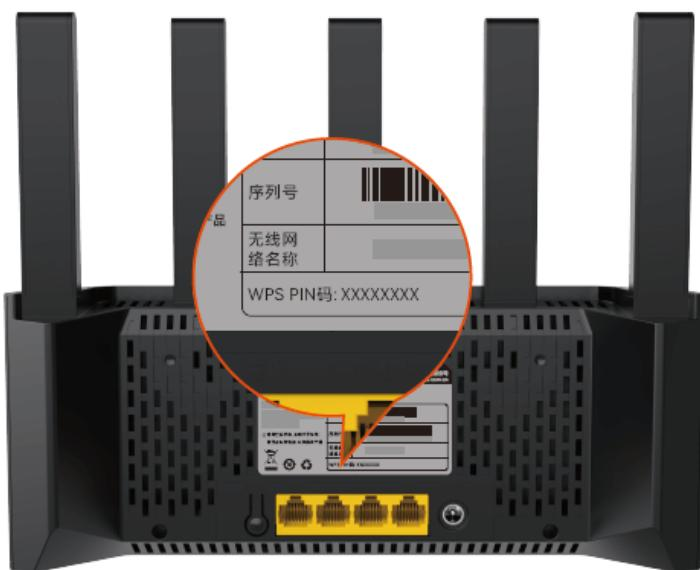
**步骤 2** 在无线终端设备上输入路由器的 WPS PIN 码进行连接，**2 分钟内**，连接成功。
