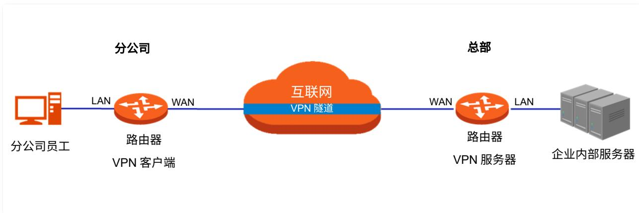
路由器支持 PPTP (Point to Point Tunneling Protocol, 点对点隧道协议) 和 L2TP (Layer 2 Tunneling Protocol, 二层隧道协议)。
