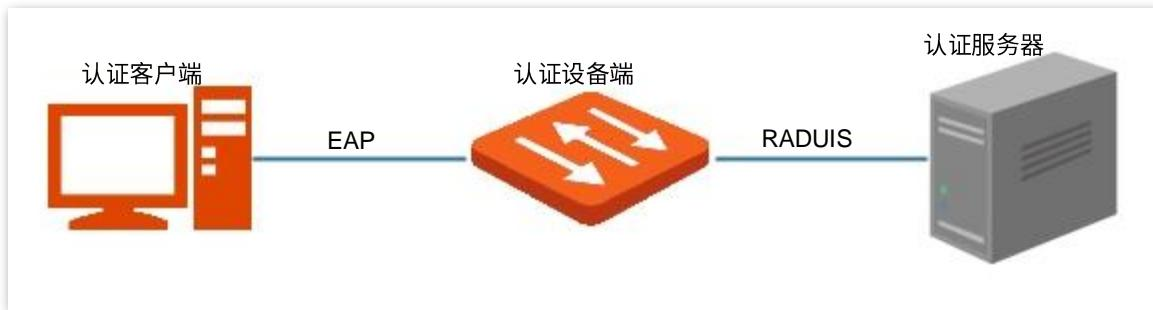
本交换机只支持基于端口的接入认证方式。如果端口下某一用户认证成功，则端口变为授权状态，其他后续接入此端口的用户无需认证即可访问网络资源，当该用户下线后，端口变为非授权状态，此端口下的所有用户会被拒绝访问网络资源。
