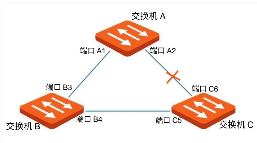
经 STP 计算过后，交换机 A 被选为根桥，端口 A2 和端口 C6 之间的线路被阻塞。
